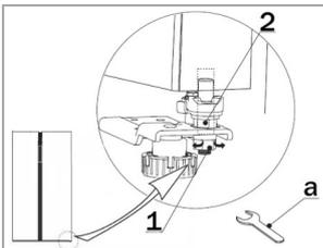
Öffnen Sie die Tür, lösen Sie die Sicherungsmutter (1) mit einem Schraubenschlüssel (a)..
